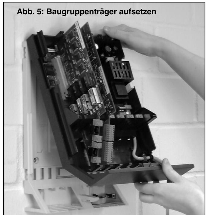
Abb. 5: Baugruppenträger aufsetzen
