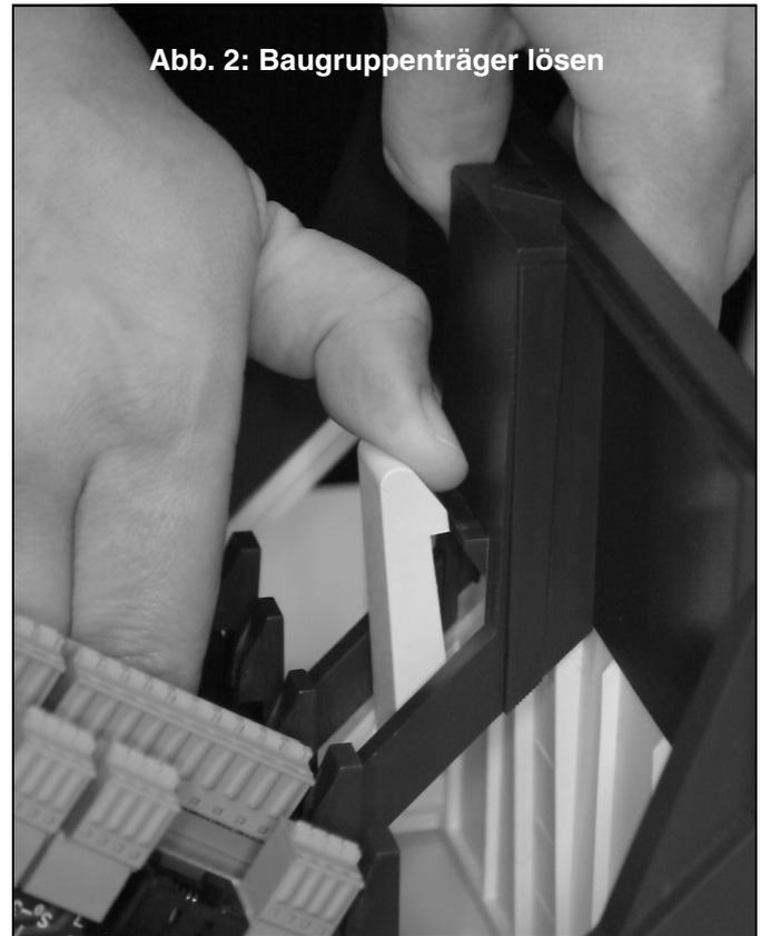
Abb. 2: Baugruppenträger lösen
